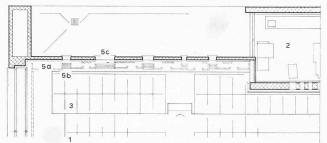
Grundriss der schallabsorbierenden Aula-Rückwand 1:150 1 Aula, 2 Filmkabine, 3 Empore, 5a Holzpfeifen, 5b Radiator, 5c Verdunklungs-Schiebewände
