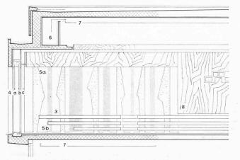
Ansicht der Aula-Rückwand mit Schnitt durch Saalfenster, 1:150 3 Empore, 4 Kastenfenster, 4a Lamellenstoren, 4b Verdunklung, 4c Vorhang, 5a Holzpfeifen, 5b Radiator, 6 Zuluftkanal, 7 perforierte Metalldecke, 8 Naturholzverkleidung
