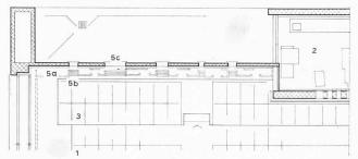
Grundriss der schallabsorbierenden Aula-Rückwand 1:150 1 Aula, 2 Filmkabine, 3 Empore, 5a Holzpfeifen, 5b Radiator, 5c Verdunklungs-Schiebewände
