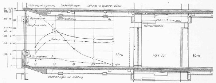
Bild 2. Normale Anordnung der Leuchten. 1 Tageslichtquotient (TLQ) in  $^{0}$ 0, bzw. natürliche Beleuchtungsstärke  $E_{n}$  in Lux bei einer Aussenbeleuchtung von 6000 Lux, 2 künstliche Beleuchtung  $E_{e}$ , total, 3 künstliche Beleuchtung, Anteil Deckenleuchten, 4 künstliche Beleuchtung, Anteil Kämpferleuchten
