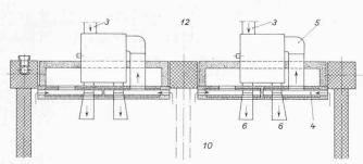
Bild 4. Einbau von zwei Umluftgeräten nach Bild 3 in einem Direktionszimmer im achten Obergeschoss (Novelair AG). Aufriss 1:30 und Grundriss 1:60
