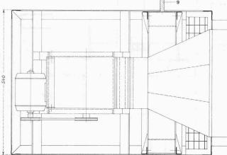
Bild 3. Umluftgerät mit Luftkühler für 400 m³/h, 1:10
