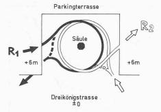
Bild 11. Schema der Rampenlage R1 = Abfahrtrampe R2 = Auffahrtrampe
