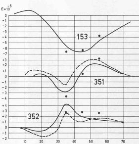
Bild 14. Einflusslinien für Dehnungen in Rampenlängsrichtung für Einzellast von 4000 kg in Rampenmitte ( $+=\mathrm{Zug}$ )
