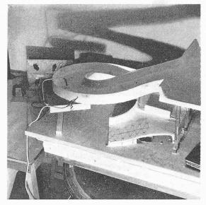
Bild 16. Modellversuch für die Rampe, Material: englischer Zement mit Drahtnetzeinlage, E  $\sim$  140 000 kg/cm², Querdhaussach 0.00 kg/cm², Querdhaussach 0.00
