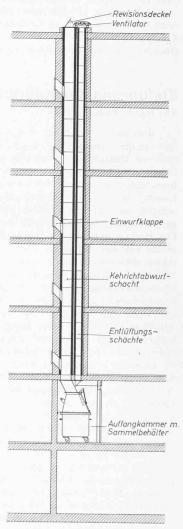
Bild 3. Schnitt 1:150 durch eine Kehrichtabwurfanlage
