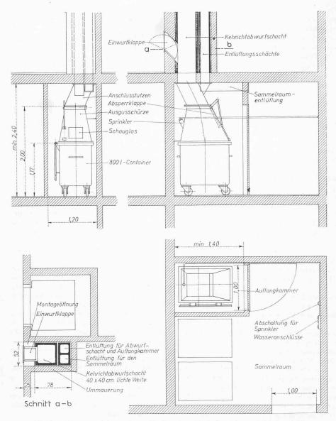
Bild 4. Auffangkammer und Sammelraum für Container 800 I. Grundriss und Schnitte 1:60
