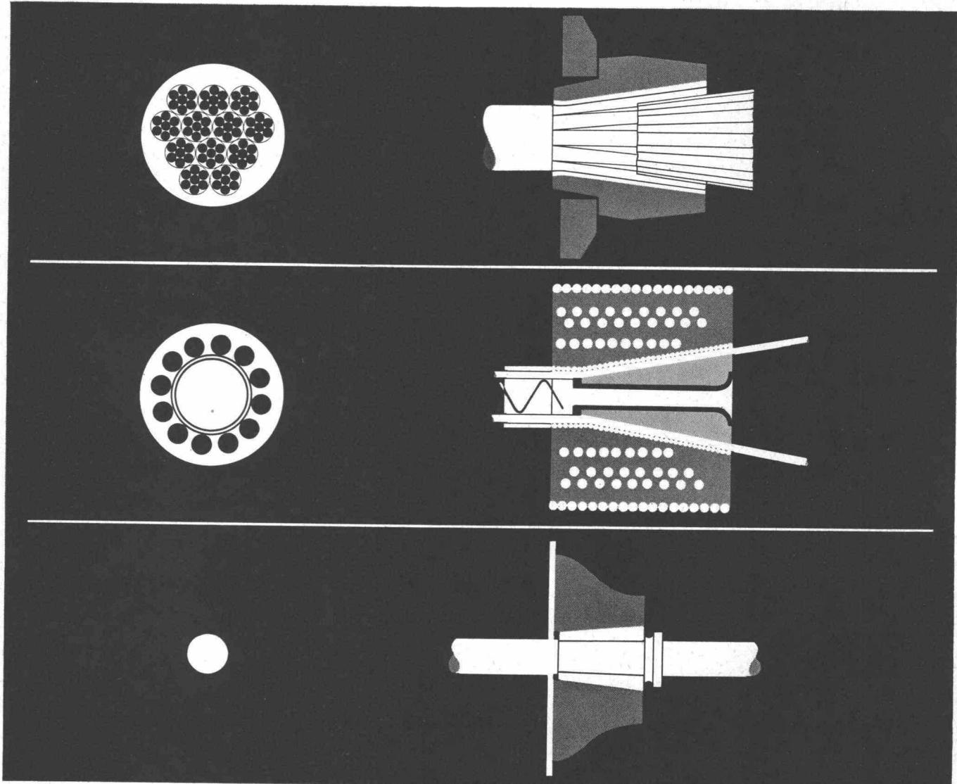
Ob mit 12 Litzen, 12 Drähten oder als Eindraht-Einheit – jedes Freyssinet-Vorspannkabel hat die gleichen Eigenschaften: Alle sind robust, leicht zu handhaben und besitzen einfache, absolut sichere Verankerungen.
