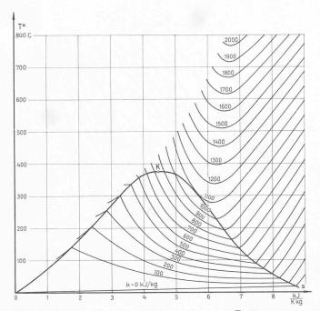
Bild 2.1. Kurven gleicher Koenthalpie für Wasser im  $T ext{-}s ext{-} ext{Diagramm}$
