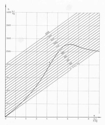
Bild 2.3. Kurven gleicher Koenthalpie für Wasser im  $h ext{-}s ext{-}$ Diagramm
