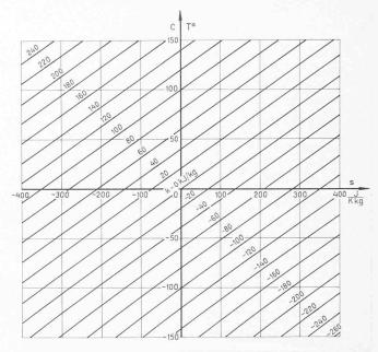
Bild 2. 2. Kurven gleicher Koenthalpie für Luft im T-s-Diagramm
