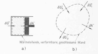
Bild 3. 1. Geschlossene thermodynamische Systeme
