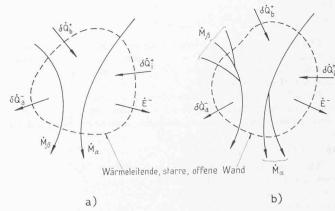
Bild 4.2. Darstellung der Massenflüsse, die ein offenes, stationäres thermodynamisches System durchströmen
