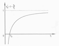
Bild 3. 2. Carnotwirkungsgrad  $\eta^{~i}_a$  in Funktion der Temperatur  $T_{ii}$  mit welcher die Wärme von der Wärmequelle i aufgenommen wird
