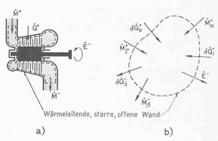
Bild 4.1. Offene, stationäre thermodynamische Systeme a) einfaches System, b) allgemeines System
