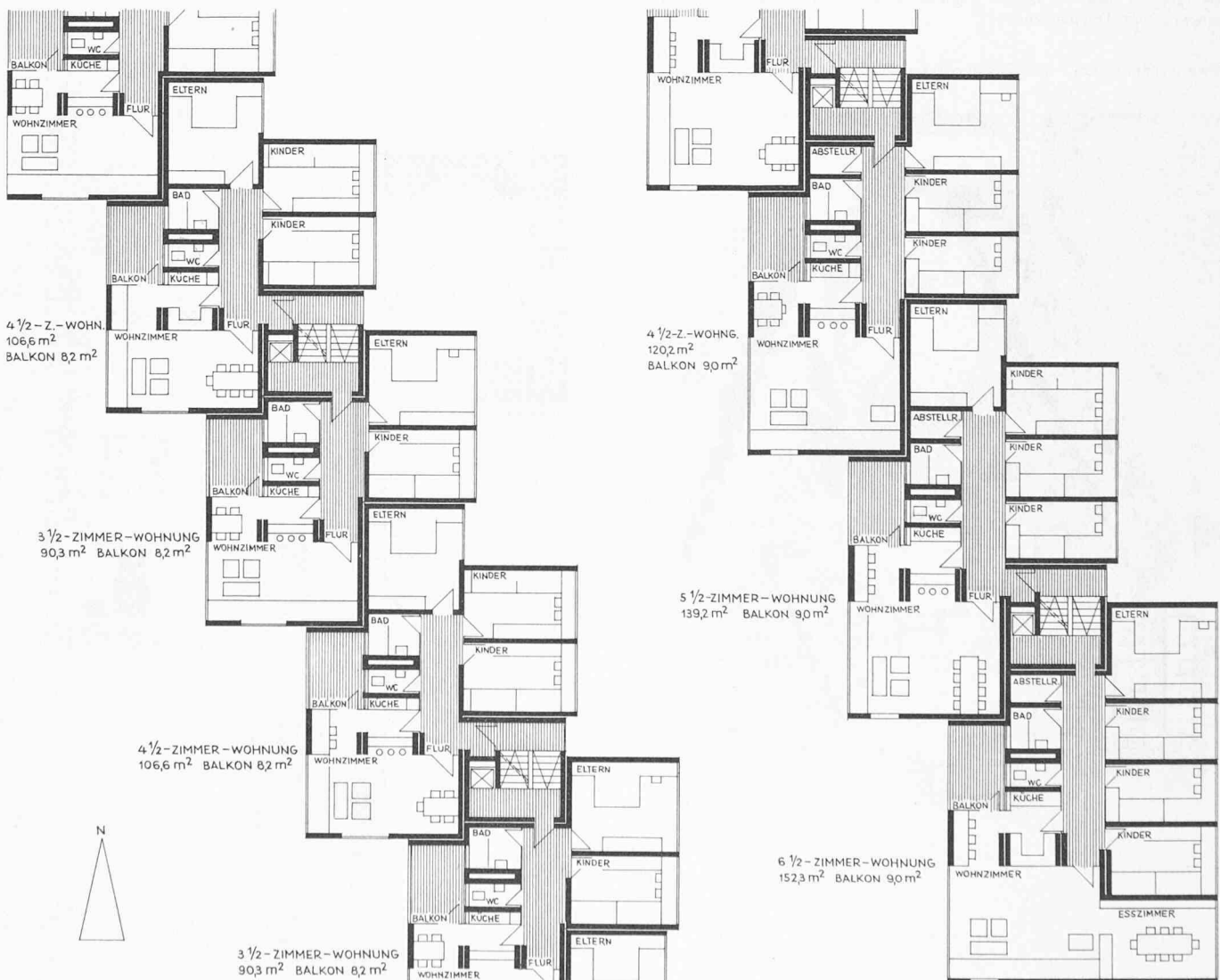
Bilder 7 und 8. Möglichkeiten der gestaffelten Anordnung von Wohnungseinheiten. Grundrisse 1:300
