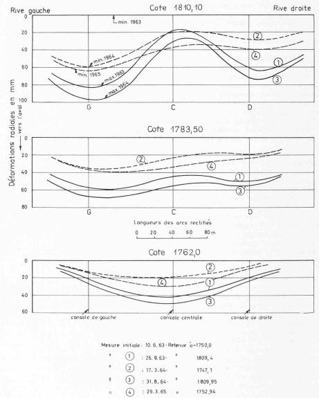
Fig. 5. Déformations radiales mesurées sous les retenues maxima et minima
