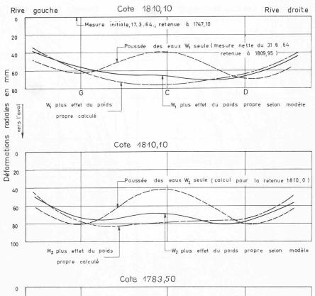
Fig. 7. Déformations radiales nettes pour la poussée maximum des eaux et le poids propre. Valeurs calculées en régime élastique pour  $E_b=175\,000~{\rm kg/cm^2}$  et valeurs mesurées nettes à partir du début de la deuxième mise
