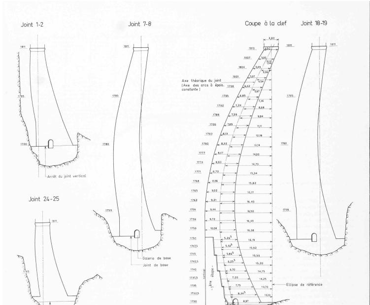
Fig. 2. Coupes en travers du barrage des Toules. Echelle 1:600. Pour l'emplacement des joints, voir coupes en long, fig. 3, pages 776'777
