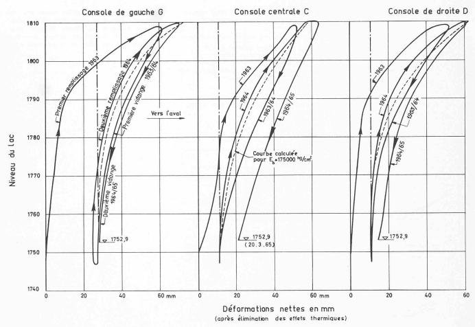
Fig. 6. Déformations radiales nettes à la cote 1783,50 en fonction du niveau du lac
