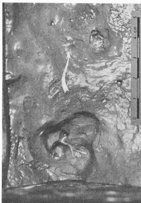
Bild 10. Kolkversuche: Detailaufnahme eines seitlichen Kolkloches von oben
