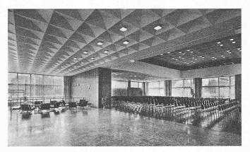
Geöffnete Faltwände ermöglichen, den kleinen und den grossen Saal sowie das Foyer für Grossanlässe räumlich zusammenzuziehen
