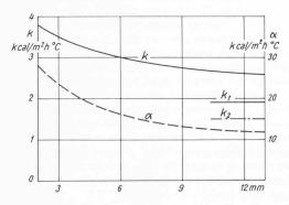
Bild 3. k- und  $\alpha$ -Werte von Doppelscheiben in Abhängigkeit von der Luftpolsterdicke  $k_1$  für Stop-Ray-Verglasung ohne Storen,  $k_2$  für Stop-Ray-Verglasung mit Storen
