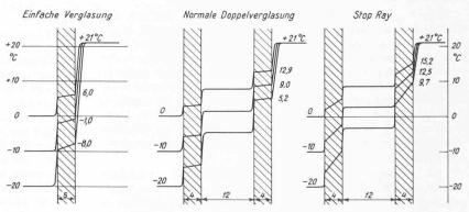
Bild 4. Temperaturverlauf bei einfacher, bei normaler Doppelverglasung und bei Stop-Ray-Verglasung für eine Innentemperatur von 21 ° C und tiefe Aussentemperaturen. Man beachte die Oberflächentemperaturen auf der Innenseite
