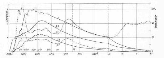
Bild 2. Durchlässigkeitsmessungen von Thermopane- und Stop-Ray-Glas mit Spektralphotometer Zeiss PMQ II Kurve 1: Spektrum der Sonnenstrahlungsenergie
