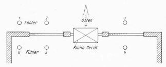
Bild 9. Anordnung der Messtellen. Fenster links mit Stop-Ray-Verglasung, Fenster rechts normale Doppelverglasung
