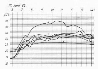
Bild 8. Temperaturverlauf im Versuchsraum ohne Klimabetrieb
