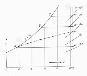
Bild 5 (links). Raumzustände A', B', C', und zugehörige Taupunkte A, B, C im t, x-Diagramm
