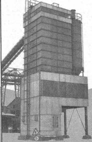
Leistung ca. 40—50 m³/h 2 Sorten Zement à 50 t Inhalt 4 Zuschlagstoffe à 30 m³ Inhalt 1 Zwangsmischer, 1500 l Inhalt Lochkarten-Steuerung Beschickung der Anlage durch Schrägförderband
