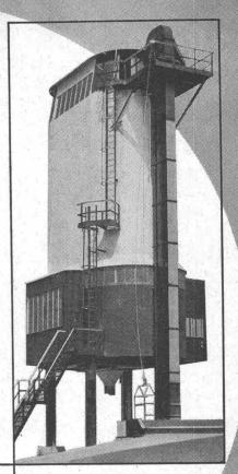
Leistung ca. 80—100 m³/h 4 Sorten Zement à 20 t Inhalt 8 Zuschlagstoffe à 22 m³ Inhalt 1 Zwangsmischer, 2600 i Inhalt Elektronische Steuerung mit Lieferschein-Druckwerk Beschickung der Anlage durch Elevator G 100 mit 100 m³/h
