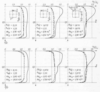
Bild 13b. Kanal mit tiefer, mittelbreiter Nische ( $t_N/d=1,875$ ,  $t_N=30$  mm;  $b_N/t=3,75$ ,  $b_N=60$  mm), oben grosse Luftgeschwindigkeiten, unten kleine Luftgeschwindigkeiten, Düsenstellungen entsprechend den Querschnittskizzen oben
