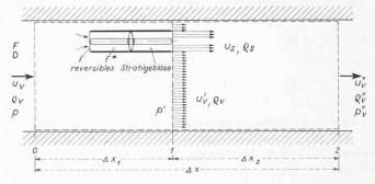
Bild 9. Kanalausschnitt mit Treibstrahldüse und den verwendeten Bezeichnungen. Gestrichelt der Bereich, für den der Impulssatz angewendet wird
