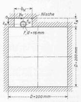
Bild 8b. Querschnitt durch den Versuchskanal mit Nische von der Breite  $b_N$  und der Tiefe  $t_N$  und den Koordinaten der Treibstrahldüse  $y_N$  und  $z_N$
