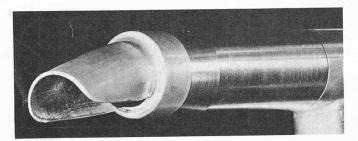
Bild 14. Treibstrahldüse mit Strahlablenkung durch Haube
