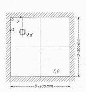
Bild 8a. Querschnitt durch den Versuchskanal ohne Nische mit den Koordinaten y, z der Treibstrahldüse
