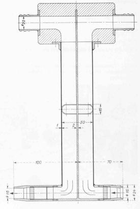
Bild 2 (rechts). Längsschnitt durch die Treibstrahldüse, 1:3
