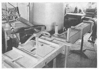
Bild 3 (links). Versuchskanalstück mit ausgebauter Treibstrahldüse und Nischeneinbau
