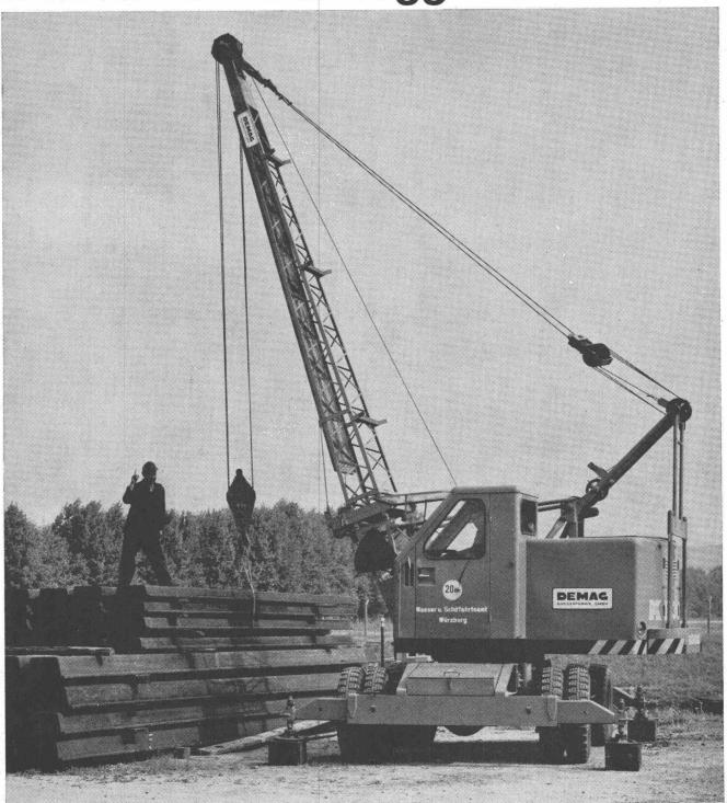
Neben der Normalausführung mit kurzem Unterwagen liefert die DEMAG ein Gerät in verlängerter Ausführung, den KB 303 V. Die besonderen Vorzüge dieser Geräte: verstärkte Achsen für hohe Achslasten, enger Wendekreis, grosse
