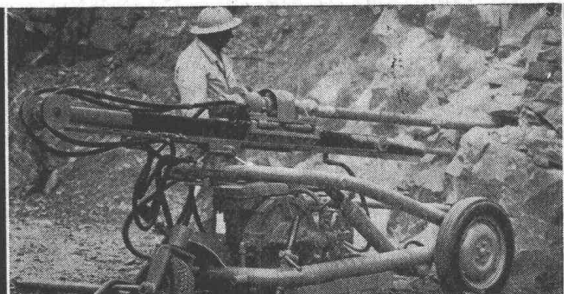
Grosslochbohrwagen mit hydraulischem Antrieb für Lochhämmer
