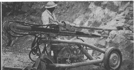
Grosslochbohrwagen mit hydraulischem Antrieb für Lochhämmer
