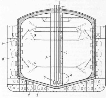
Bild 1. Querschnitt durch das Tankschiff «Jules Verne»
