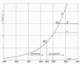
Bild 1. Jährlicher Weltverbrauch an Erdöl in Milliarden t. A, B und C sind Extrapolations-Varianten des künftigen Erdölkonsums
