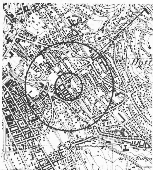
Bild 2. Illustrationsbeispiel einer mehr oder weniger gleichmässig verteilten Bevölkerung. Die 0,3- bzw. 3,0-atü-Isobaren entsprechen den zu erwartenden Schadenradien für ungeschützte und optimal geschützte Personen. Massstab 1:25 000.
