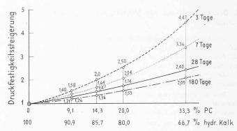
Bild 17. Würfeldruckfestigkeit des mit 66,7 bis 90,9 % hydraulischem Kalk verlängerten Zementmörtels, bezogen auf die Druckfestigkeit des hydraulischen Kalkmörtels. Alter: 3 bis 180 Tage
