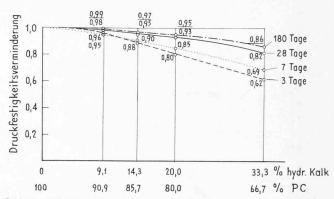
Bild 20. Würfeldruckfestigkeit des mit 9,1 bis 33,3 % hydraulischem Kalk verlängerten Portlandzementmörtels, bezogen auf diejenige des reinen Portlandzementmörtels im Alter von 3 bis 180 Tagen. Bindemittel/Sand 1:4 Gewichtsteile, Konsistenz: plastisch
