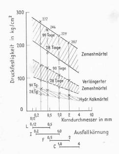
Bild 11 (links), Würfeldruckfestigkeit der drei Mörtelarten in Abhängigkeit vom Ausfallkornband, aufgetragen über dem mittleren Korndurchmesser des Bandes. Alter: 28 und 90 Tage
