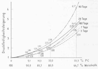
Bild 18. Würfeldruckfestigkeit des mit 66,7 bis 90,9 %0 Weisskalk verlängerten Portlandzementmörtels, bezogen auf die Druckfestigkeit des reinen Weisskalkmörtels im Alter von 3 bis 180 Tagen. Bindemittel/Sand 1:4 in Gewichtsteilen, plastische Konsistenz
