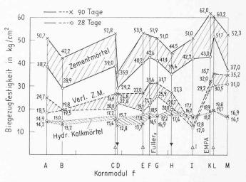
Bild 9. Biegezugfestigkeit der drei Mörtelarten in Abhängigkeit vom Kornmodul. Prismengrösse 4 imes 4 imes 16 cm, Alter: 28 und 90 Tage
