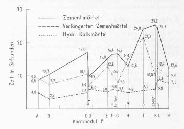
Bild 14. Tropfensaugfähigkeit in Sekunden der drei Mörtelarten, in Abhängigkeit vom Kornmodul aufgetragen
