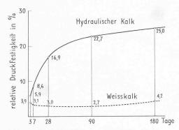
Bild 16. Würfeldruckfestigkeit des hydraulischen Kalkmörtels und des Weisskalkmörtels, bezogen auf diejenige des Zementmörtels im Alter von 3 bis 180 Tagen. Zusammensetzung des Mörtels wie Bild 15
