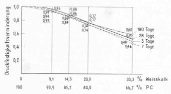
Bild 19. Würfeldruckfestigkeit des mit 9,1 bis 33,3 % Weisskalk verlängerten Portlandzementmörtels, bezogen auf diejenige des reinen Portlandzementmörtels im Alter von 3 bis 180 Tagen
