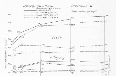
Bild 1. Festigkeit von Normenmörtelprismen bei verschiedener Lagerung
