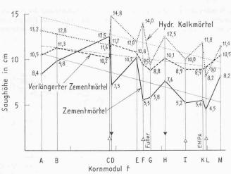
Bild 13. Saughöhe nach 6 Stunden der drei Mörtelarten in Abhängigkeit vom Kornmodul, Ausgleichsgeraden durch die Schwerpunkte je dreier Versuchspunkte
