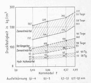
ist eine lineare Druckfestigkeitsabnahme mit dem mittleren Durchmesser des Ausfallbandes festzustellen, wobei allerdings zu berücksichtigen ist, dass mit zunehmendem Kornmodul der Wasserzusatz geringer gewählt worden ist.
