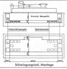
Abgefedertes Fundament Präzisions. Schleifmaschine
