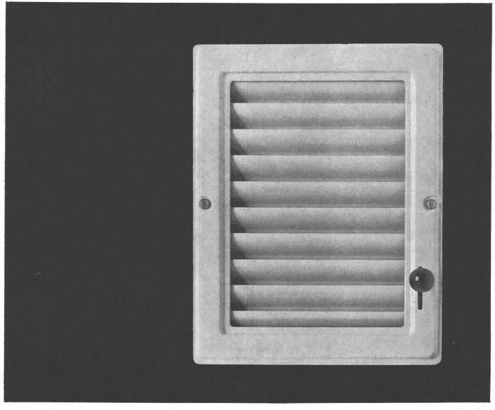
Für Entlüftung und Belüftung von Badezimmern, Küchen, Treppenhäusern, für Warmluftheizungen etc. Luftklappe mit gepresstem Rahmen und gut schliessenden Lamellen, elfenbeinfarbig lackiert, Mauerrahmen verzinkt.
