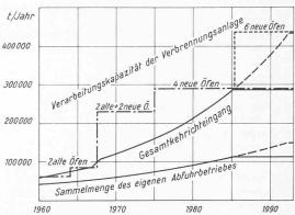
Bild 3. KVA Basel: voraussichtliche Entwicklung der Kehrichtmengen für Verbrennung und Abfuhr und der Verarbeitungskapazität der Verbrennungsanlagen
