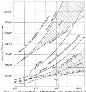
Voraussichtliche Entwicklung der Wärmeproduktion der KVA Basel und des Wärmeverlustes des Fernheizungs-
