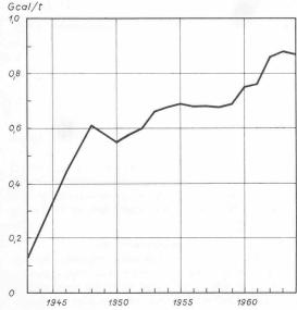
Bild 1. Entwicklung der spezifischen Wärmeproduktion in  $\operatorname{Gcal}/\operatorname{t}$  Kehricht der KVA Basel
