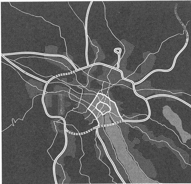
Bild 4. Das von Kanton und Stadt Zürich entwickelte Netz der Hochleistungsstrassen im Raume der Region Zürich. Autobahnen, Autobahnring, Stadtkerntangenten, Cityring und Radialstrassen
