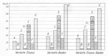
Abwasserreinigungsanlage Basel, Graphische Darstellung der bereinigten Bau- und kapitalisierten Betriebskosten, Index 1961
