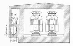
Bild 5. Tiefbahn mit Zuleitung zur ARA Basel und Werkleitungskanal, Schnitt 1:200
