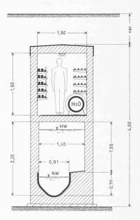
Bild 6. Zuleitung zur ARA Basel mit Werkleitungskanal, Schnitt 1:80
