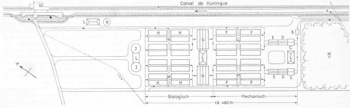
Bild 3. Schema der Abwasserreinigungsanlage im Elsass
