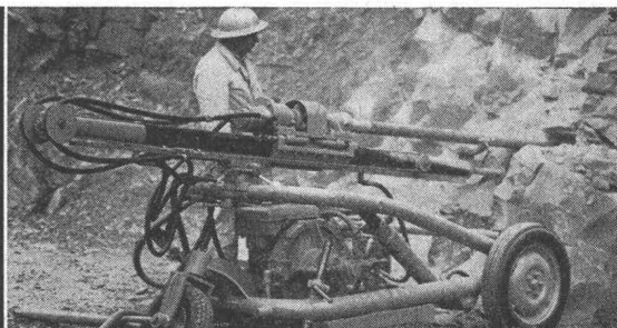
Grosslochbohrwagen mit hydraulischem Antrieb für Lochhämmer
