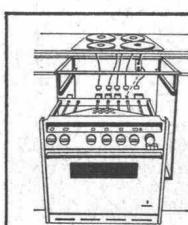
Mit wenigen Handgriffen sind die Kochplatten mit den Steckverbindungen angeschlossen und der Herd auf
