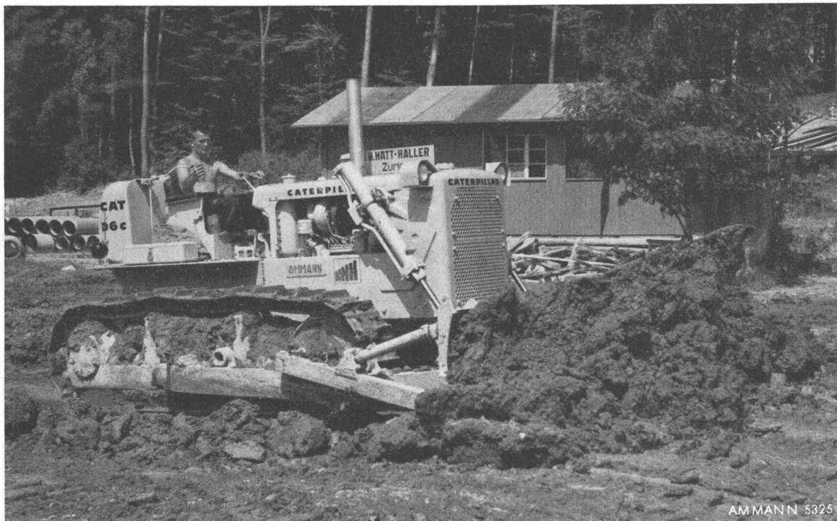
**Der 120-PS-Motor** mit Turboaufladung verleiht der D6C eine Leistungsfähigkeit grosser Bulldozer.
