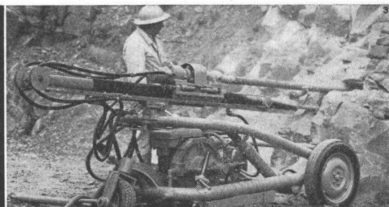
Grosslochbohrwagen mit hydraulischem Antrieb für Lochhämmer
