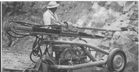
Grosslochbohrwagen mit hydraulischem Antrieb für Lochhämmer
