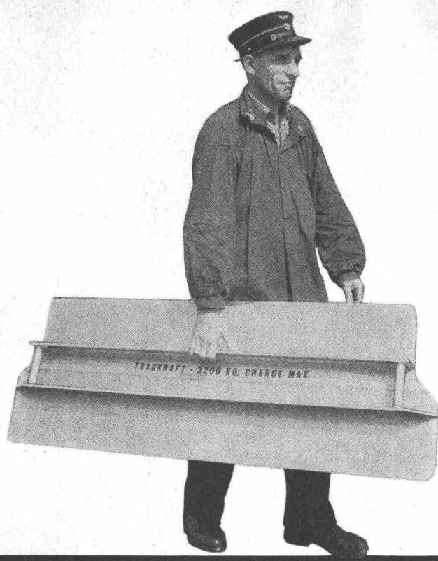
Das Verladepersonal schätzt täglich die leichte und stabile Aluminiumübergangsbrücke. Sie kann mit über 3 Tonnen belastet werden, wiegt je nach Modell nur 23 bis 30 kg und rostet nicht. Dieses von der schweizerischen Studiengesellschaft für rationellen Güterumschlag (SSRG) mit Erfolg geprüfte Hilfsmittel der Verladetechnik hat sich bei Bahnen, Industrie und Gewerbe schon gut eingeführt.
