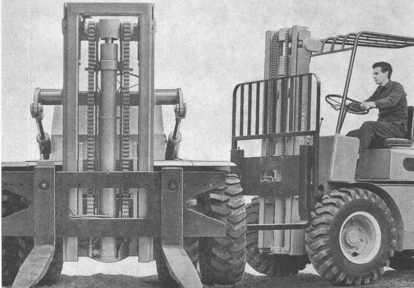
Credé-Gabelstapler mit Diesel- oder Benzinmotor bewähren sich auch unter schwersten Bedingungen: auf Lagerplätzen im Freien, in der Holz-, Baustoff- und Maschinenindustrie, in allen Situationen wo es auf Anpassungsfähigkeit, ständige Einsatzbereitschaft, Robustheit und Leistungsreserve ankommt. Verschiedene Modelle von 1000-6000kg Tragkraft, z.Teil in geländegängiger Ausführung, mit oder ohne automatischem Getriebe stehen zu Ihrer Verfügung.
