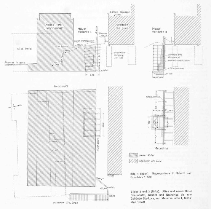
ausserdem über den Bentonitschlitzwänden nach hinten ausladende und belastete Betonkonsolen vor. Kostenmässig erwies sich Variante II gegenüber Variante I schon dadurch überlegen, dass die Grundstückfläche etwas besser ausgenützt werden konnte. Ausserdem waren bei ihr Nachrutschungen des Bodens an den Schachtbrüsten ausgeschlossen. Die Entwässerung hinter der Mauer sollte vermittelst 7 Filterbrunnen der Firma Stump Bohr AG erfolgen.
