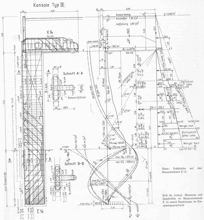
Bild 8. Mauerelement E:14 mit Konsole Typ IV, Armierung und statische Untersuchung. Längen 1:125
