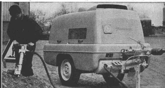
neuer, lärmarm, vollkommen luftgekühlter 4 m 3 -Kompressor
