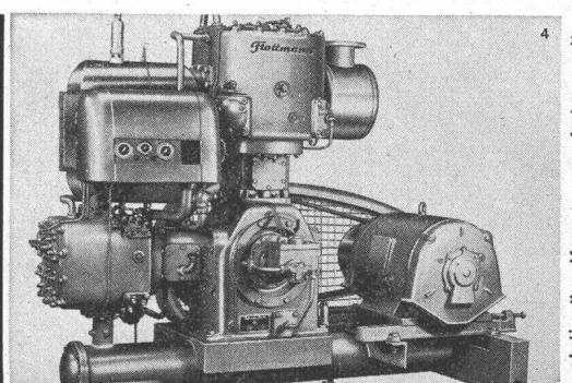
stationäre Kompressor-Anlage mit
