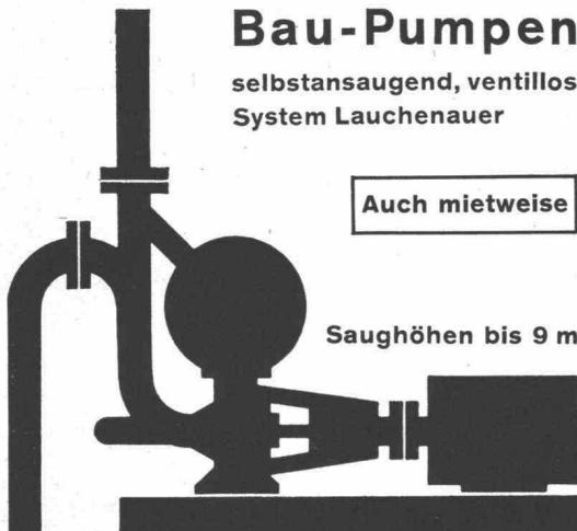
Leistungen 1—500 l/sec. Kein Bodenventil. Keine Klappe im Saugstutzen. Keine Hilfs-Vakuum-Pumpe. Jederzeitiges automatisches Ansaugen auch nach Lufteintritt im Saugrohr. Keine reibenden, sich abnutzenden Dichtungsflächen, daher störungsfrei auch bei Schlamm-, Sand- und Kiesförderung.
