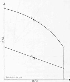
Bild 6. Verlauf der dampfseitigen und kältemittelseitigen Temperaturen in Abhängigkeit von der übertragenen Wärmemenge bei Solekühlung
