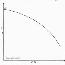
Bild 4. Verlauf der Temperaturdifferenz zwischen den dampfseitigen und kältemittelseitigen Sättigungstemperaturen, dargestellt in Abhängigkeit von der übertragenen Wärmemenge
