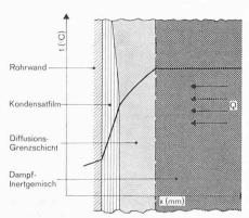
Bild 2. Parallele Darstellung des *Temperatur-verlaufes in der Grenzschicht* bei reinen Dämpfen (oben) bzw. bei Dampf-Inertgas-Gemisch (unten). Bei letzterem erhöht die inertgasreiche Diffusions-Grenzschicht den Widerstand des Wärme- bzw. Stoffüberganges
