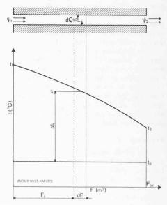
Bild 3. Interpretation der örtlichen Temperaturdifferenz  $\Delta t_i$  in einem Kondensator für Dämpfe
