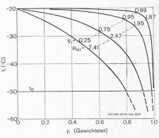
Bilder 11 und 12. Temperaturverlauf bei einigen möglichen Chlorverflüssigungs-Betriebsfällen. Erst nach der Verflüssigung der überwiegenden Menge des Chlors, das heisst bei höheren Werten für  $y_1$ , tritt bei hoher Eintrittskonzentration ein merklicher Temperaturabfall ein
