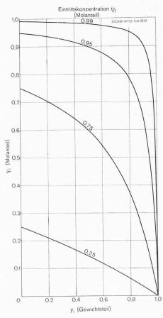
Bild 10. Verlauf der momentanen Gemischkonzentration  $\psi_l$  in Abhängigkeit vom schon erreichten Verflüssigungsgrad  $y_l$  bei verschiedenen Eintrittskonzentrationen  $\psi_l$
