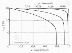
Bild 13. Integral-Mittelwert der Temperaturdifferenz,  $\Delta t_m$  zu Bild 12, in Abhängigkeit vom fortschreitenden Verflüssigungsgrad  $y_i$  bei einer Kältemitteltemperatur von —50° C. Der Mittelwert weicht bei kleinen Ausbeuten von der Temperaturdifferenz am Eintritt  $\Delta t_1$  kaum ab. Erst wenn die zu erreichende Ausbeute der Chlorverflüssigung  $(y_i = y_2)$  einen bestimmten Wert überschreitet, tritt ein starker Abfall ein
