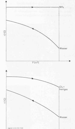
Bild 1. Die dampfseitige Sättigungstemperatur ist in einem Verflüssiger für reine Dämpfe konstant (oberes Diagramm: Temperaturbild eines wassergekühlten NH3-Kondensators), dagegen ändert sie sich entlang der Wärmeübertragungsfläche mit fortschreitender Kondensation in Verflüssigern für Dampf-Inertgas-Gemische (unteres Diagramm)
