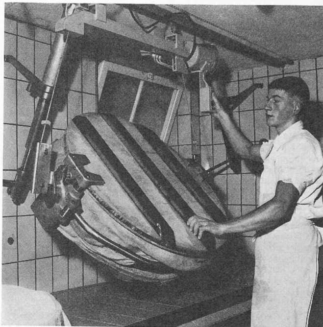
Bild 4. Das regelmässige Wenden der Käse kann mit diesem Hilfsgerät sorgfältiger und mit weniger Kraftaufwand durchgeführt werden
