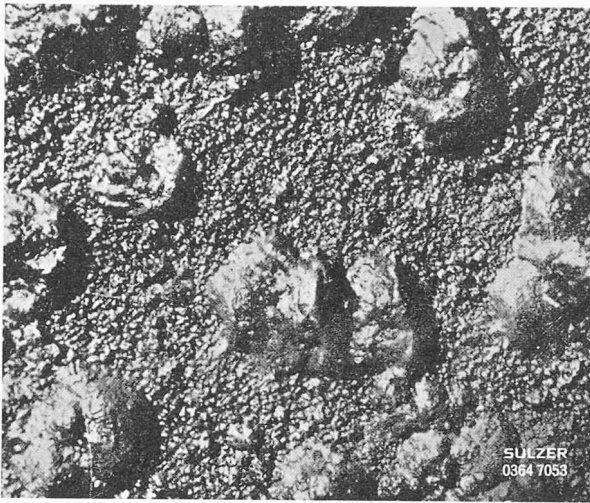
Bild 3. Druckleitung Cavaglia vor der Reinigung in natürlicher Grösse (Messstrecke 1) [7]; massgebliche absolute Rauigkeit k_s = 3,2 mm.
