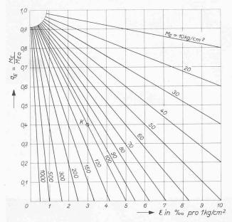
Bild 1. Berechnung von  $M_{E^0}$  in Funktion der spez. Querdehnung arepsilon und des  $M_E ext{-Wertes}$
