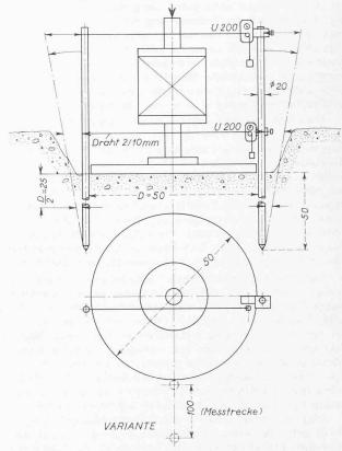
Bild 2. Plattenversuch mit Querdehnungsmessung (schematisch) Masse in cm
