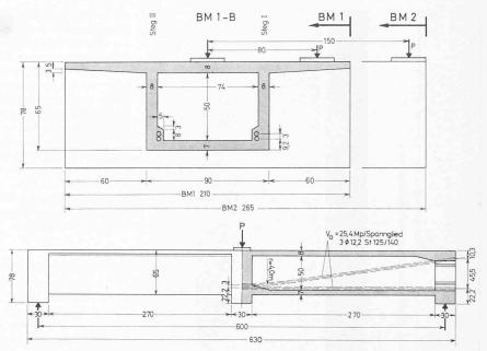
Bild 2. Versuchskörper, Ansicht und Längsschnitt 1:60, Querschnitt 1:30
