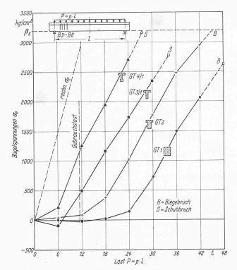
Bild 10. Mittlere Bügelspannungen bei Gleichlastbalken mit verschiedenen Stegbreiten
