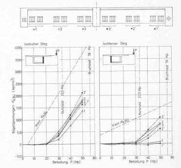
Bild 12. Mittlere gemessene Bügelspannungen  $\sigma_{e,B\ddot{u}}$  des Trägers BM 2
