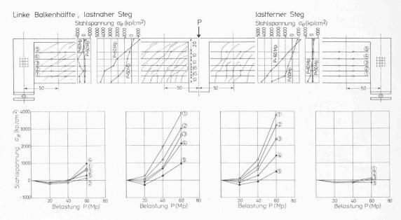
Bild 11. Gemessene Stahlspannungen  $\sigma_e$  in der horizontalen Stegbewehrung des Trägers BM 1 unter ausmittiger Belastung (ohne Berücksichtigung der Vorspannung)
