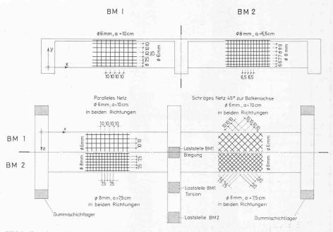
Bild 3. Bewehrung der Stege und Bodenplatten der beiden Träger BM 1 und BM 2
