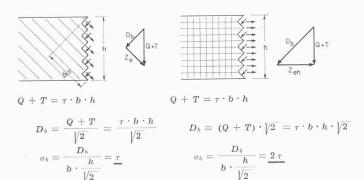
Bild 7. Aus den Gleichgewichtsbedingungen abgeleitete innere Kräfte und Spannungen bei Balken mit schrägen bzw. vertikalen Bügeln
