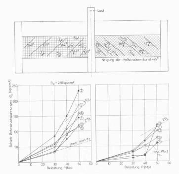
Bild 8. Gemessene schiefe Betondruckspannungen in der Bodenplatte des Trägers BM 2
