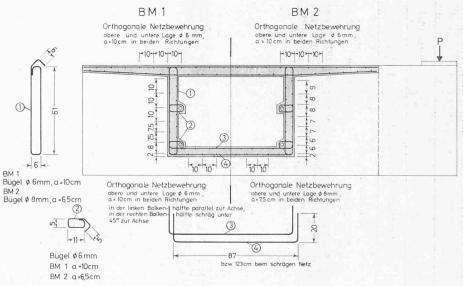
Bild 4. Bewehrungsführung im Querschnitt
