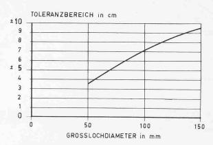
Toleranzbereich in Zentimeter für die Abweichung eines kleinkalibrigen Bohrloches gegenüber dem Grossloch im Ausschlagsbereich entsprechend Bild 6a
