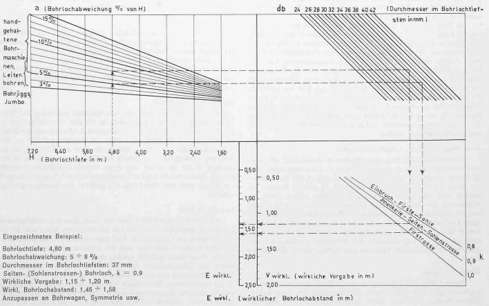
Bild 8. Nomogramm zur Bestimmung von V wirkl, und E wirkl, als Funktion von H, a, db und k
