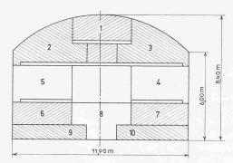
Bild 4. Beispiel für die Einteilung in Mineurbereiche beim Bohren und Laden in einem 90 m²-Tunnel bei zweideckigem Bohrwagen und zehn Mineuren. Ziffern und schraffierte Bereiche = Mineurbereiche
