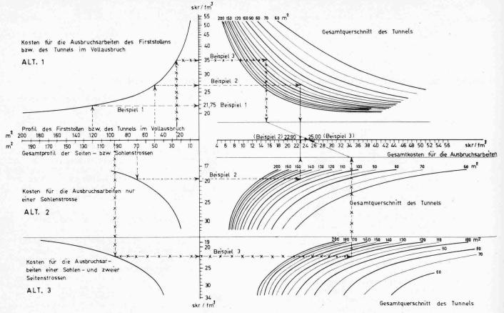
Bild 1. Nomogramm zur Ermittlung der Gesamtkosten für die Ausbruchsarbeiten (Bohren, Laden, Sprengen, Schuttern und Transport) in grossen Profilen bei verschiedener Grösse der Firststollen-, Seiten- und Sohlenstrossenprofile (vgl. auch Handbuch für Sprengarbeiten 8:52—24, A. Nystedt)
