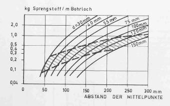
e) Zusammenhang zwischen Ladungsmenge und Lochabstand beim Sprengen gegen ein nicht geladenes Einbruchsloch, Der schattierte Bereich entspricht dem Ausschlagsbereich in Bild 6a
