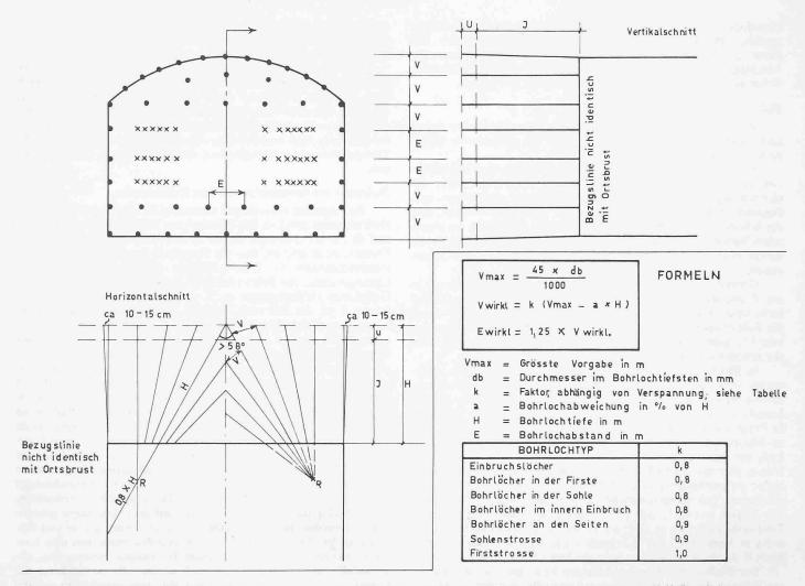
Bild 7. Faustregeln für die Anordnung der Bohrlöcher beim Keileinbruch (nach Handbuch für Sprengarbeiten 6:02—11 u.f., K. H. Fraenkel)
