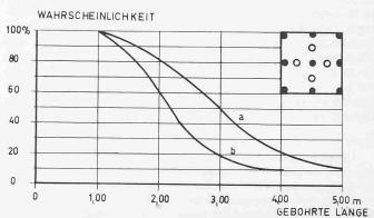
ZWANGSGESTEUERTES BOHREN OHNE RICHTPUNKT a) homogenes Gestein b) 5%Bohrerabweichung durch zerklüftetes Gestein
