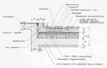
Bild 15. Aufbau der Pistenplatte, 1:30
