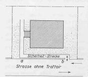
Der Verbindungsweg vom Hauseingang zum Gartentor wird nicht mehr rechtwinklig in die Strasse geführt, sondern unmittelbar an der Strasse abgewinkelt. Er verläuft dem Gartenzaun entlang und öffnet sich möglichst nahe am entgegengesetzten Ende der Anstossfront gegen die Strasse. Diese Weganlage bietet in folgender Weise Schutz: Das Kind, das den Garten verlassen will, muss auf der Strecke a-b zwangsläufig dem sich nähernden Fahrzeug entgegengehen (laufen), sieht es
