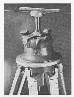
Bild 9. Stativkopf für Radienbestimmung mit Messdraht
