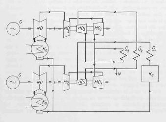
Bild 1 (links) Vereinfachter Schaltplan einer 600 MW-Einheit im Dampf-Kraftwerk La Spezia
