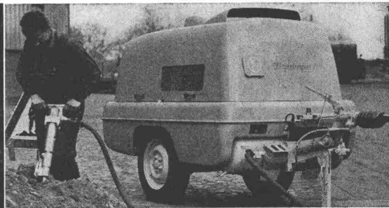
neuer, lärmärmer, vollkommen luftgekühlter 4 m 3 -Kompressor
