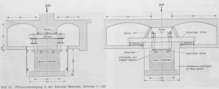
erhärtet war, wurde der alte Pfeiler mittels vier hydraulischen Pressen leicht angehoben, so dass die Kontaktfläche zwischen dem alten und dem neuen Beton richtig ausgestopft werden konnte.
