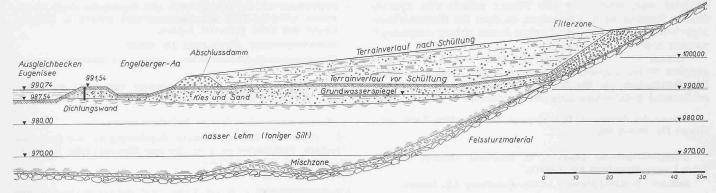
Bild 9. Schematischer Schnitt 1:1200 durch die Materialdeponie beim Eugenisee
