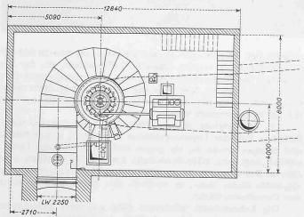
Bild 8. Zentrale des Nebenkraftwerkes mit Kaplanturbine, Masstab 1:200
