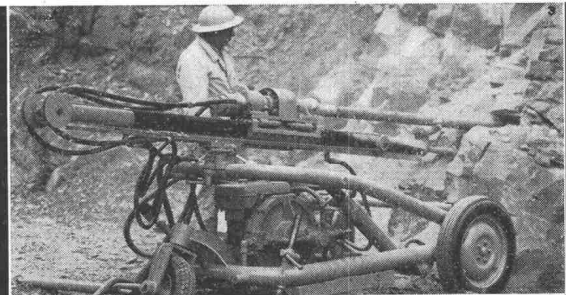
Grosslochbohrwagen mit hydraulischem Antrieb für Lochhämmer
