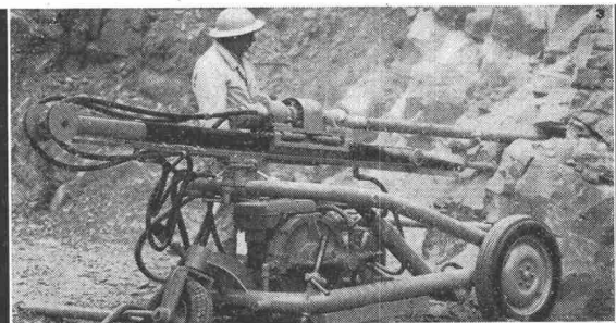
Grosslochbohrwagen mit hydraulischem Antrieb für Lochhämmer
