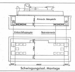
Abgefedertes Fundament einer Präzisions-Schleifmaschine
