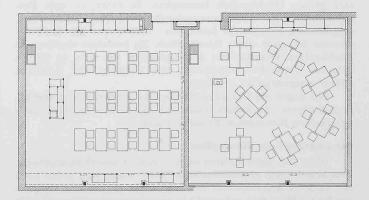
Oberstufenschulhaus Döltschi, Zürich. Bezogen 1964. Architekt H. Müller. Grundrisse Klassenzimmer; links Bestuhlung für den Frontalunterricht, rechts für den Gruppenunterricht. In jedem Klassenraum befinden sich je sechs Gas- und Elektrischanschlüsse, die auf drei Seiten verteilt sind (in den Grundrissen eingetragen), ferner ein Demonstrationskorpus für den Lehrer. Chemische und physikalische Experimente werden im Klassenzimmer durchgeführt — auf Spezialräume wurde verzichtet.
