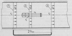
Bild 2. Prinzipskizze des Lüfungsabschnittes mit Strahlgebläse
