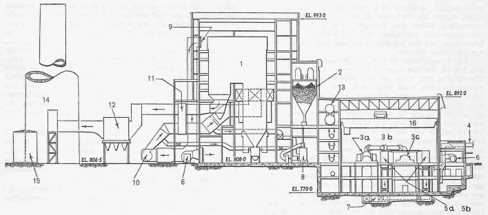
Bild 1. Querschnitt durch das Dampfkraftwerk Bull Run, 1:1050
