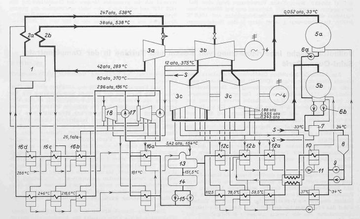
Bild 2. Schaltplan des Dampfkraftwerkes Bull Run
