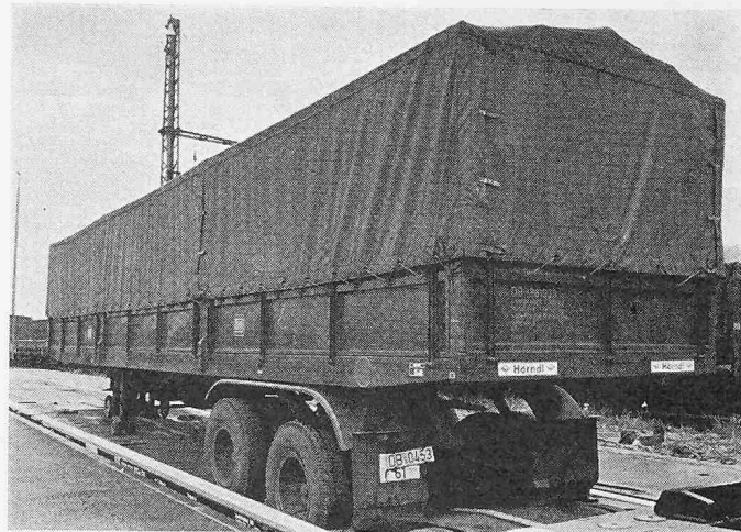
Bild 2. Für den Bahnverlad geeignetes Strassenfahrzeug mit 18,5 t Nutzlast (Huckepackverkehr der Deutschen Bundesbahn)
