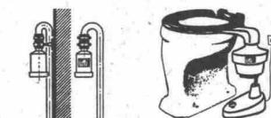
Mod. 203 Mit Halbschiene an der Sitzver schraubung befestigt
